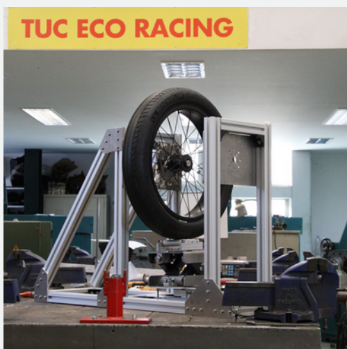
Σύστημα δοκιμής της απόδοσης και της αξιοπιστίας των τροχών
